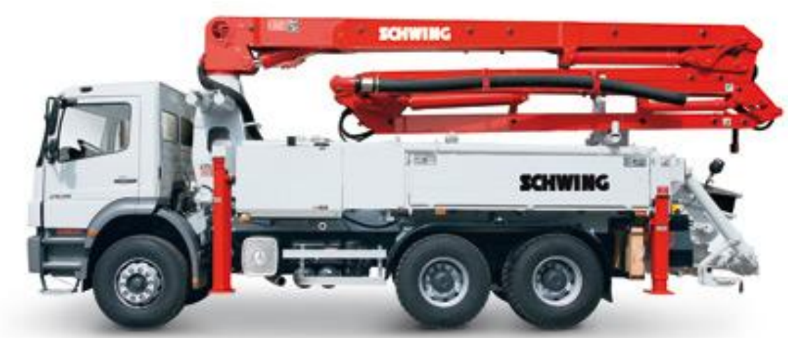
Obr. 19 Autočerpadlo SCHWING S 28 X na podvozku TATRA
