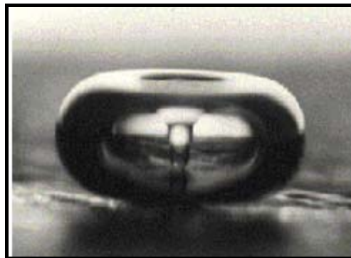
Obrázek 2: Záběr na zanikající kavitační bublinu na stěně [1]
