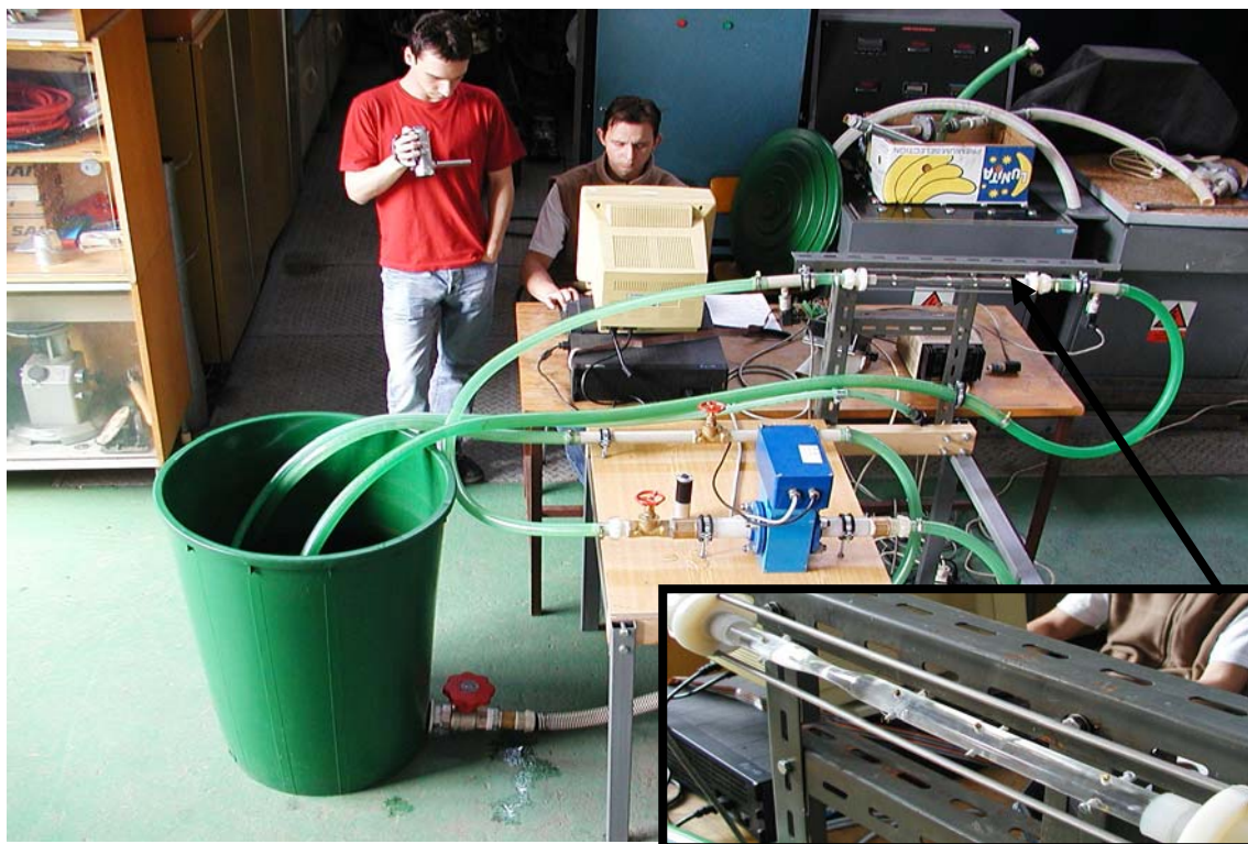
Obrázek 20: Experimentální zařízení a detail Venturiho trubice (úkol č.1)
