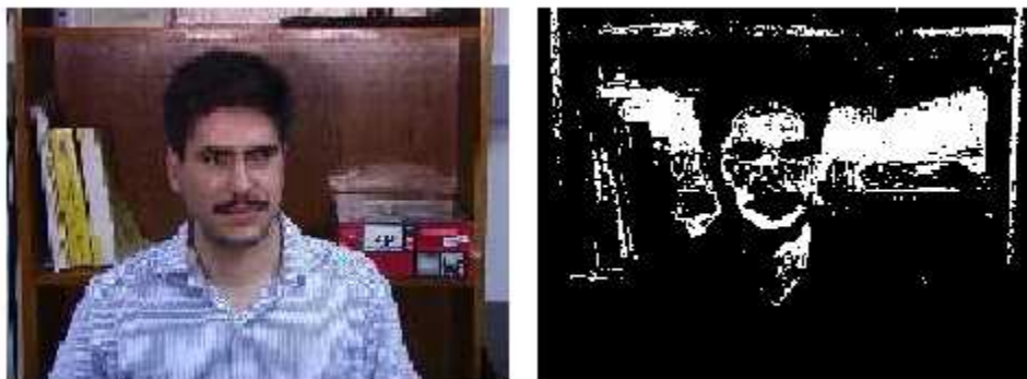
Obr.2.2: Příklad binární mapy po vyhledání bodů spadajících do barevného modelu lidské kůže[1]
