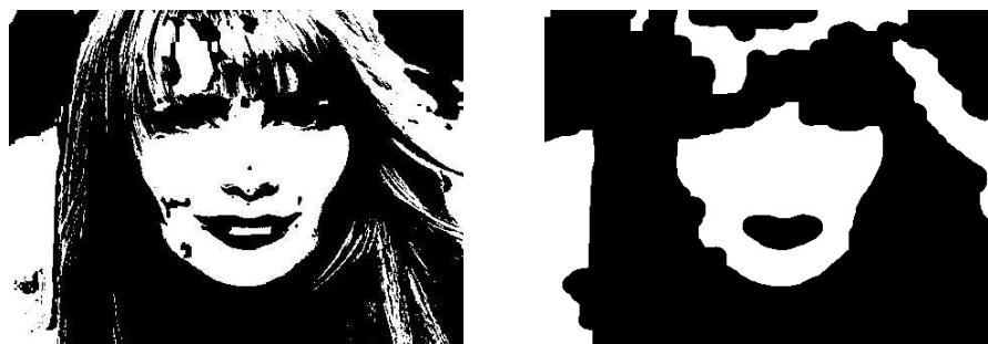
Obr.5.3: Binární mapa (vlevo) převedena na oblasti pomocí morf. Operací (vpravo)
