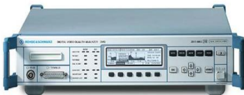
Obr. 3.1 DVQ analyzátor kvality digitálního videosignálu Rohde&Schwarz (převzato z [6])
