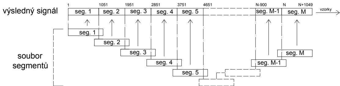
Obr. 30 : Skládání výsledného signálu při 25% překrývání segmentů
