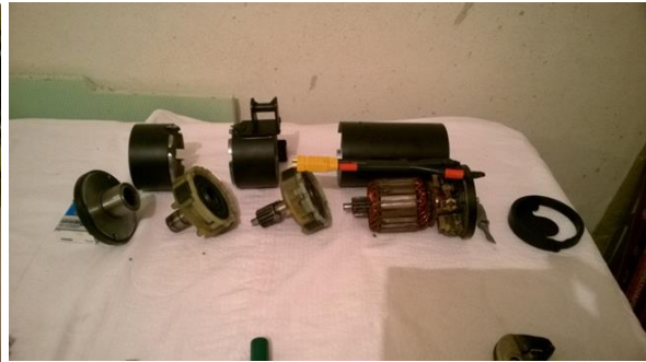
Obrázek 2: Součásti elektromotoru před sestavením (foto autor)
