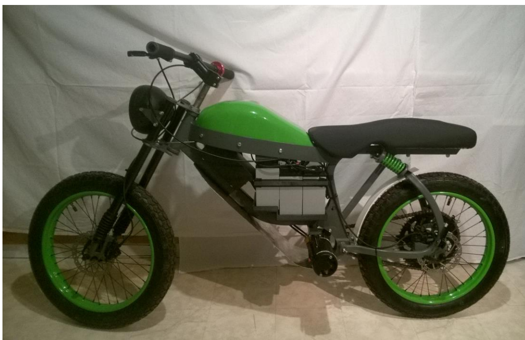
Obrázek 5: Finální podoba elektrického motocyklu (foto autor)
