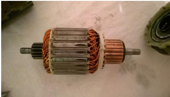
Obrázek 1: Převinutá kotva motoru (foto autora)
