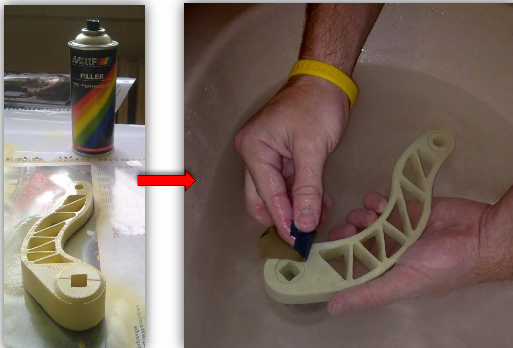
Obr. 2.4 Tmelení a následné broušení
