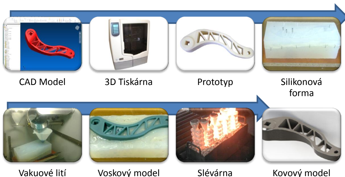
Obr. 1 Postup výroby kovového modelu pomocí metody Rapid Prototyping
