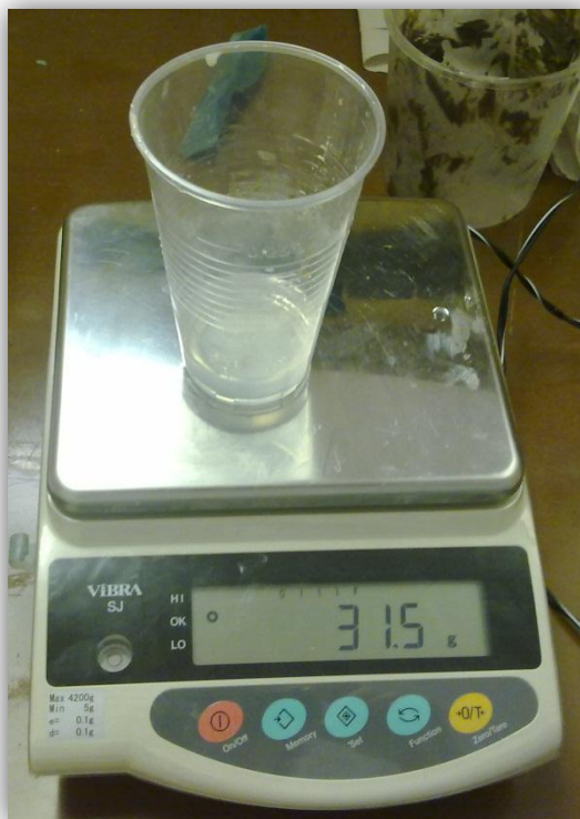
Obr. 3.1-2 Váhy Shinko Denshi Vibra SJ pro navážení silikonové směsi
