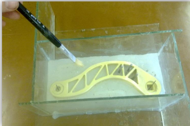
Obr. 3.1-9 Nanášení separátoru na vrchní polovinu formy s předlitými dírami
