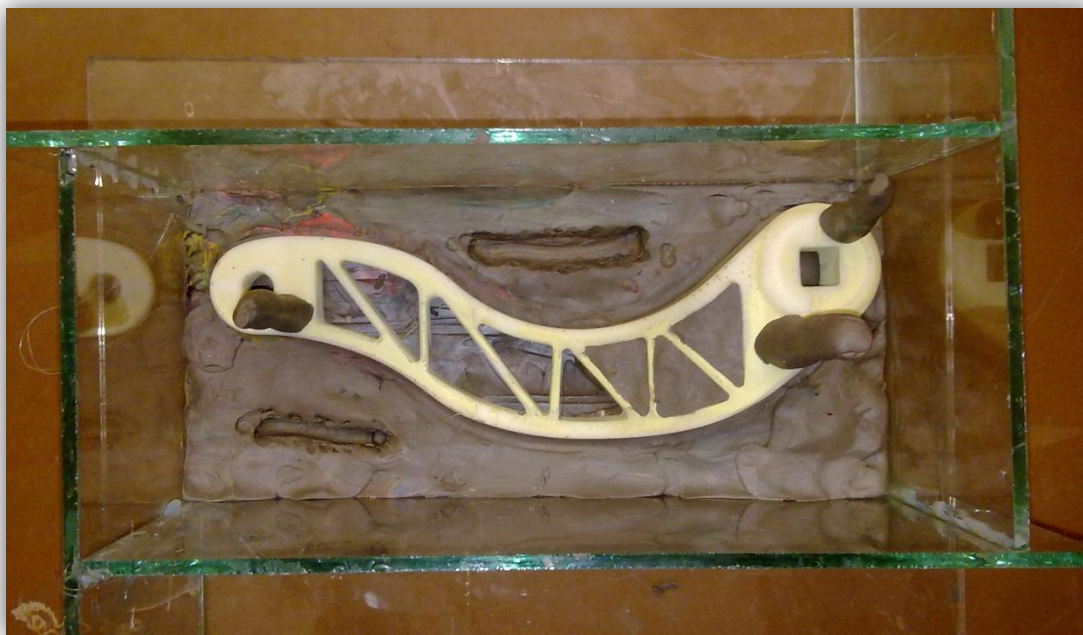
Obr. 3.1-5 Zaformování modelu s vtokovým a výfukovými kanálky
