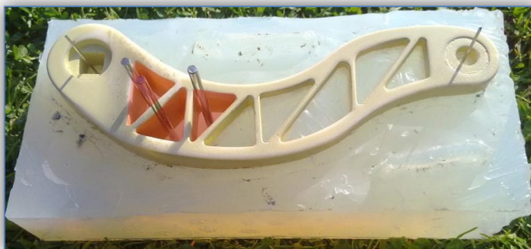
Obr. 3.1-8 Vrchní část s vodícími kolíky a znázorněnými dírami k předlévání
