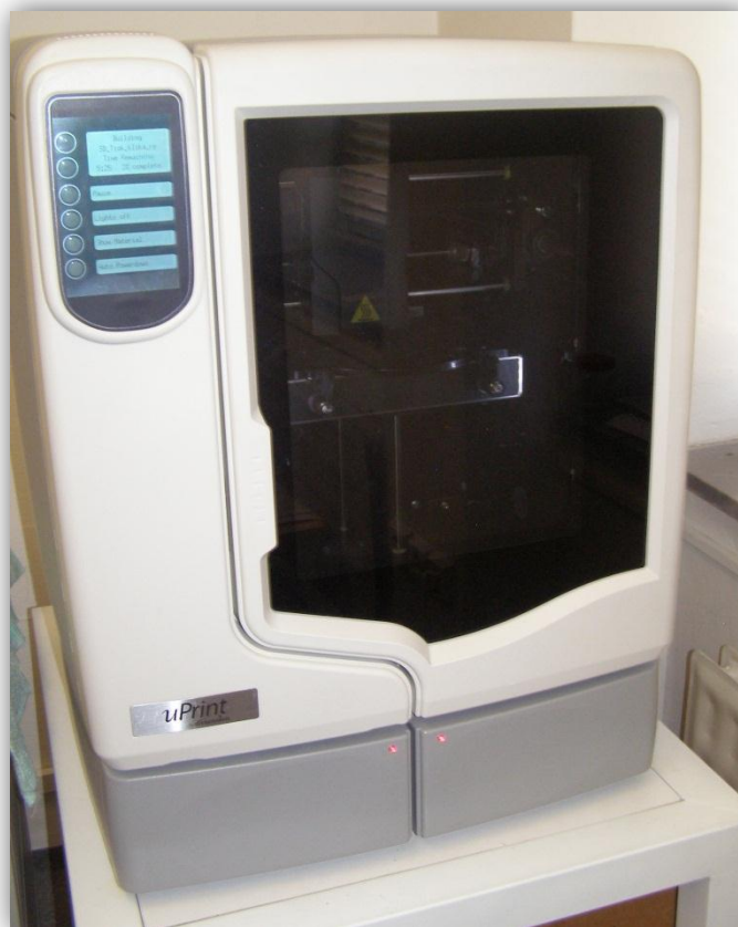
Obr. 2.3 Tiskárna uPrint při tisku master modelu kliky
