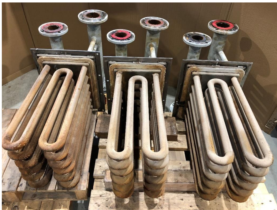
Obr. 16 Stav segmentů chladiče spalin po spalovacích zkouškách (směr proudění spalin byl zprava doleva)
