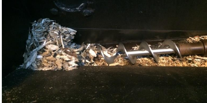
Obr. 8 Nový šnek s upravenou geometrií a délkou
