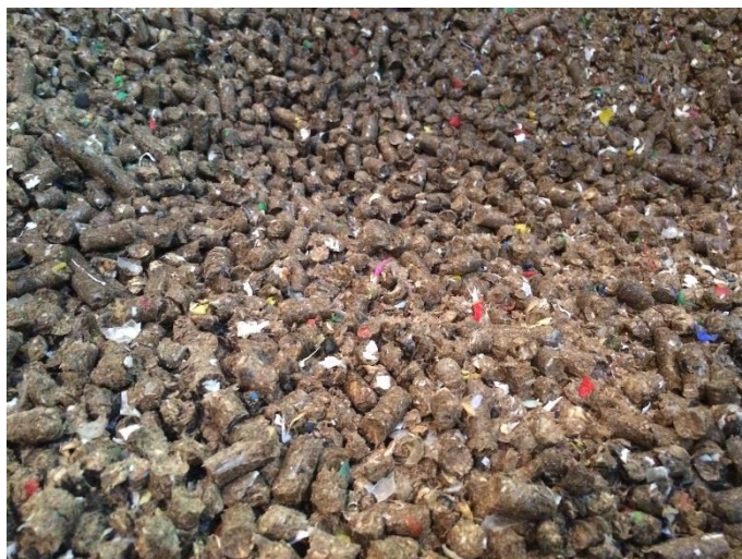
Obr. 3 Palivo TAP 1 – tříděný plastový komunální odpad s biosložkou
