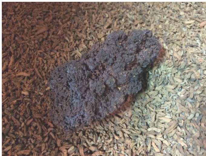
Obr. 9 Aglomeráty (až 12 cm dlouhé) v popelu při spalování KAL 1
