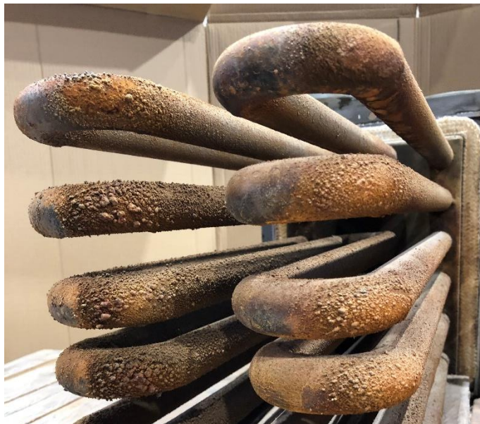
Obr. 17 Stav posledního segmentu chladiče spalin po spalovacích zkouškách (směr proudění spalin byl zprava doleva)
