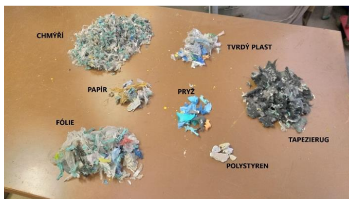
Obr. 4 Jednotlivé frakce paliva TAP 2, vzorek číslo 1
