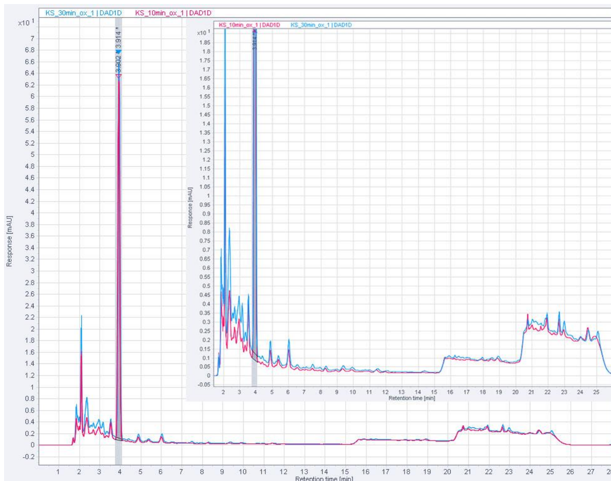
Obrázek 19 Chromatogramy znázorňující obsah FL a kofeinu ve 30min oxidované KS (modře) a 10min oxidované KS (růžově).
