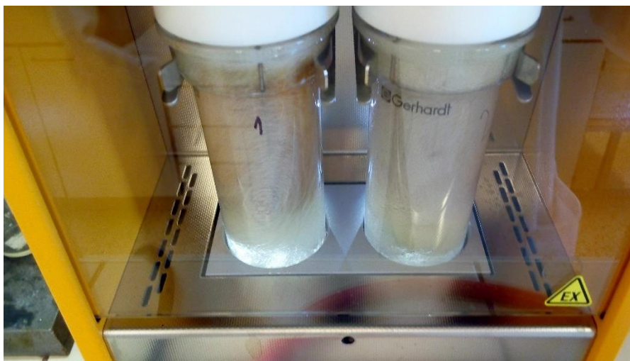
Obrázek 11 Extrakce tuků z KS pomocí jednotky Soxtherm Gerhardt
