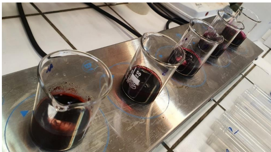
Obrázek 12 Oxidace KS pomocí oxidačního činidla na pětimístné magnetické míchače.
