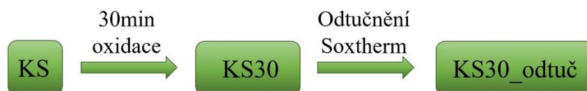
Obrázek 13 Schéma 30min oxidace KS a následného odtučnění
