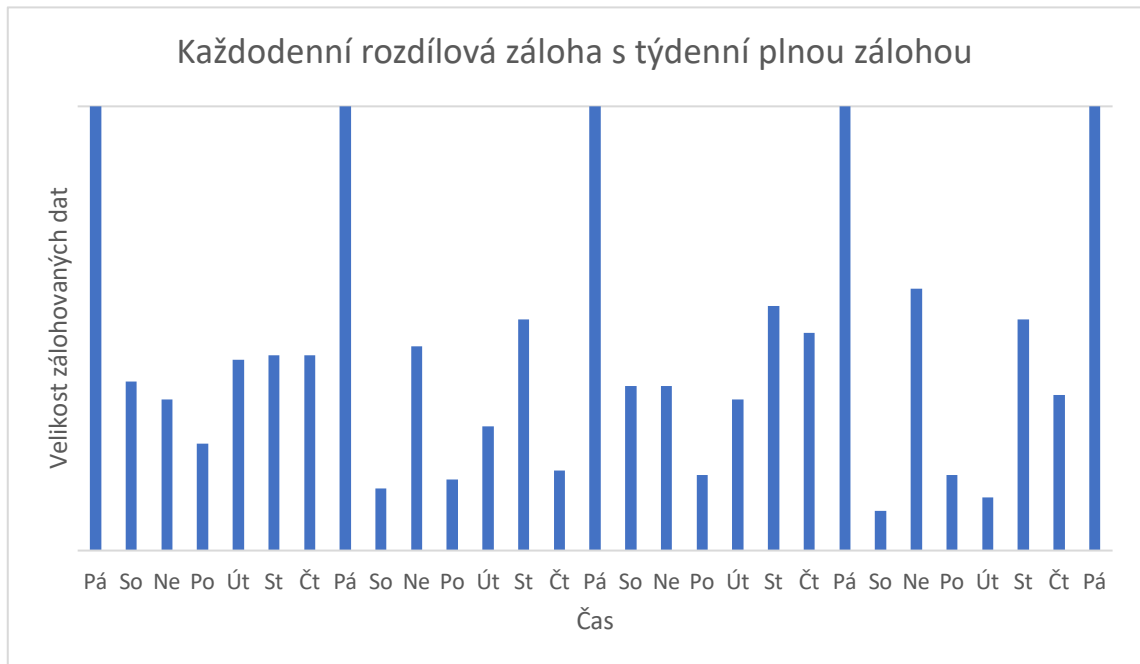
Obrázek 4 Schéma kombinovaného zálohování
