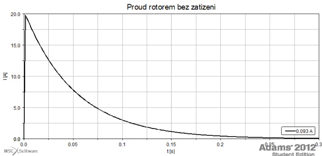
Obr. 16: Průběh proudu rotorem SSMPM bez zatížení
