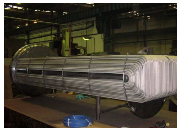
Obr. 4.5 Vlášenkový výměník tepla s U-trubkami [15]
