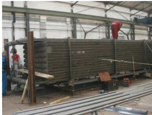
Obr. 2.8 Ohřívák vody, Elektrárna Kolín [5]
