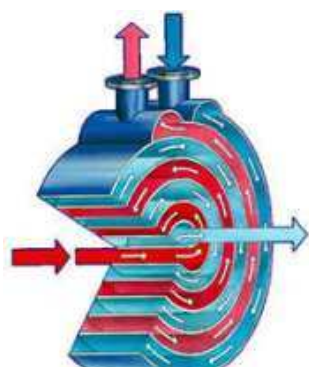
Obr. 4.11 Schéma spirálového výměníku [18]
