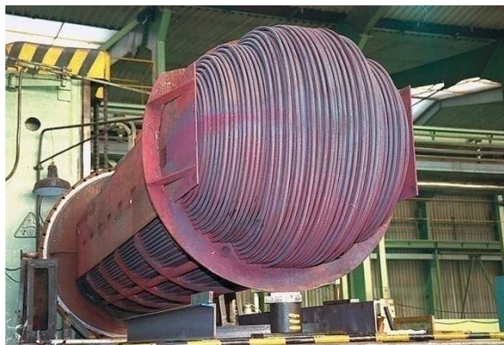
Obr. 2.11 Kondenzátor - ČEZ, a.s., Elektrárna Dětmarovice [8]
