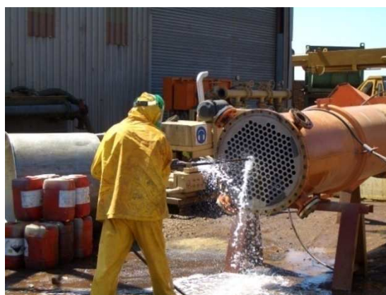
Obr 6.3 Ruční čištění trubkového výměníku
