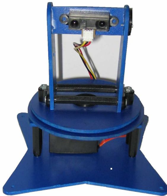
Obr. 6.1 – Otočná věž s infračerveným čidlem
