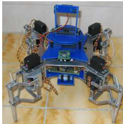
Obr. 6.4 – Umístění magnetometru na robotu
