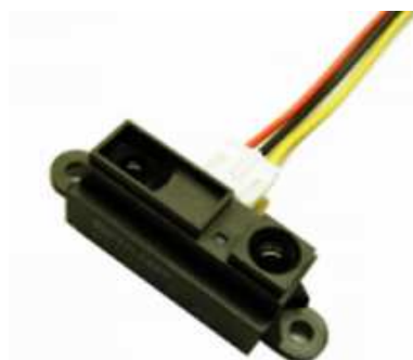
Obr. 5.13 – Infračervený snímač GP2Y0A21YK [19]
