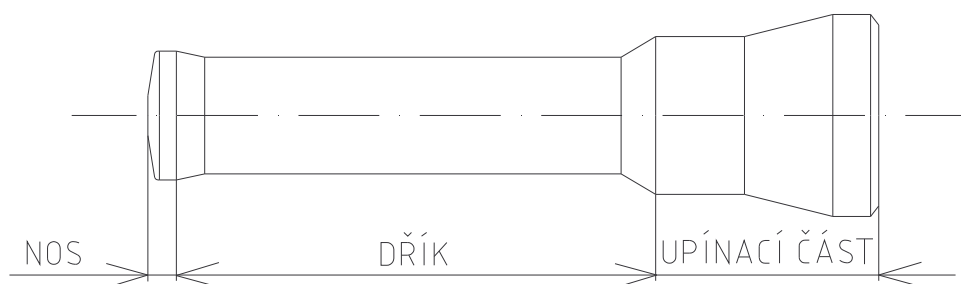
Obr.29 Doporučený tvar průtlačníku pro zpětné protlačování [2]
