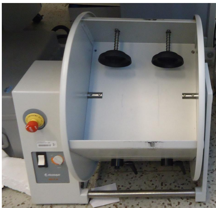
Obr. 21.: Překlopná třepačka Heidolph REAX 20 pro přípravu výluhů.
