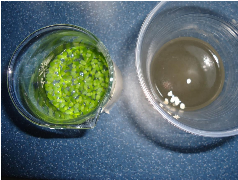
Obr. 25.: L. minor po inkubaci v neředěném výluhu kalu v porovnání se zdravou kolonií.
