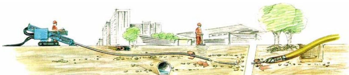
Obr. 2.2 Metoda horizontálního řízeného vrtání
