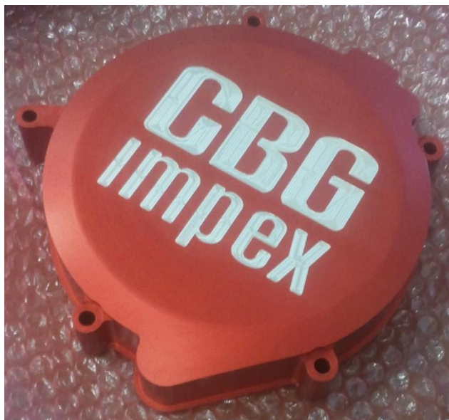
Obr. 25 Hotový výrobek Víko spojky. Povrchová úprava-eloxování.
