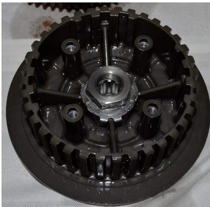
Obr. 18 Vnitřní koš spojky motoru FE 570.
