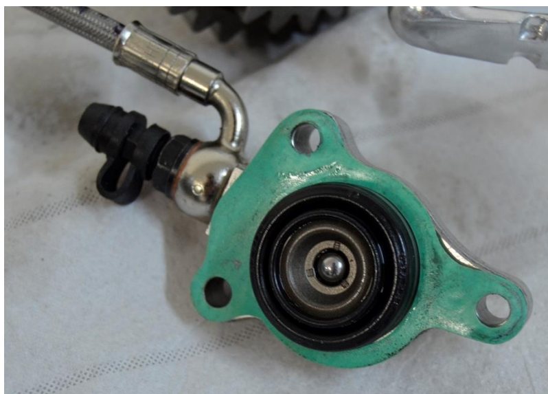
Obr. 7 Hydraulický píst ovládní spojky motoru FE 501.
