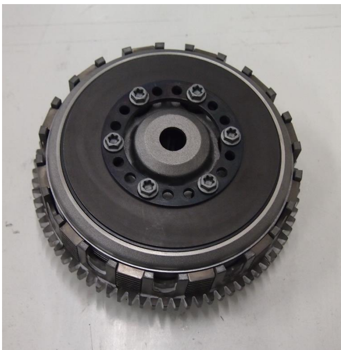
Obr. 4: Lamelové spojka motoru Husqvarna FE 501
