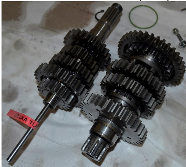
Obr. 15 Ovládací mechanismus včetně hřídelí s převodovými koly
