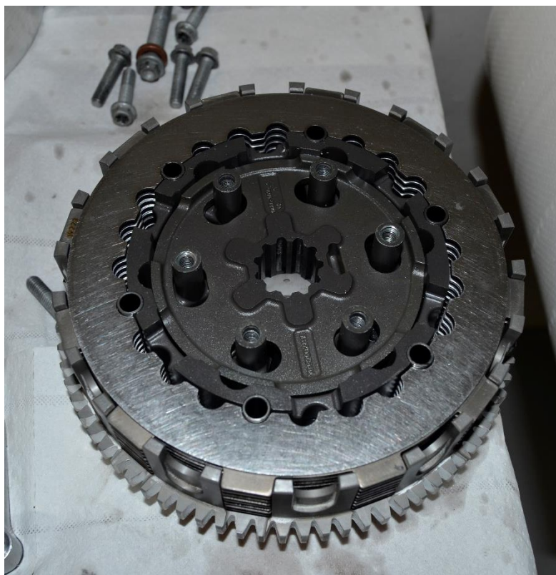
Obr. 8 Lamelový svazek vložený do vnějšího a vnitřního koše spojky.
