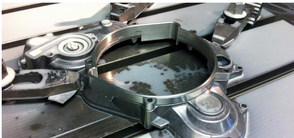
Obr. 28 Víko motoru po frézování otvoru pro osazení.
