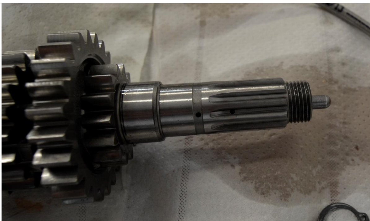
Obr. 17 Vstupní hřídel převodovky s axiálním drážkováním pro vnitřní spojkový koš, uvnitř hřídele vložena ovládací tyčka spojky.
