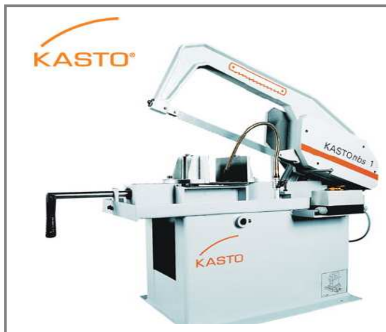
Obr.3.5 Rámová pila KASTO HBS1 (6)
