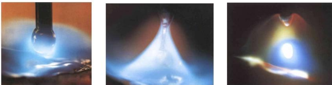
Obr. 7 Prenos kovu zľava: kvapkový, sprchový, impulzný [6].
