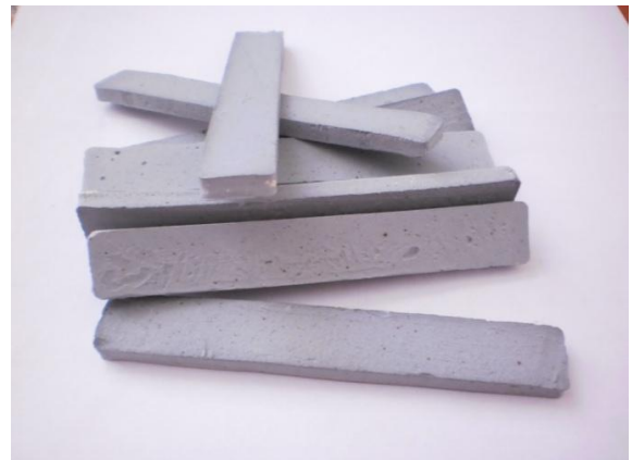
Obr. 39: zkušební vzorky 100 x 15 x 5
