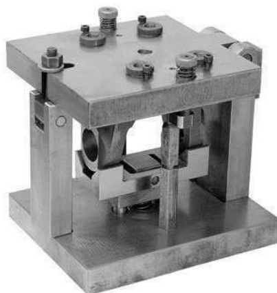
Obr. 22 – Přípravek pro vrtání do rovinné plochy [28]
