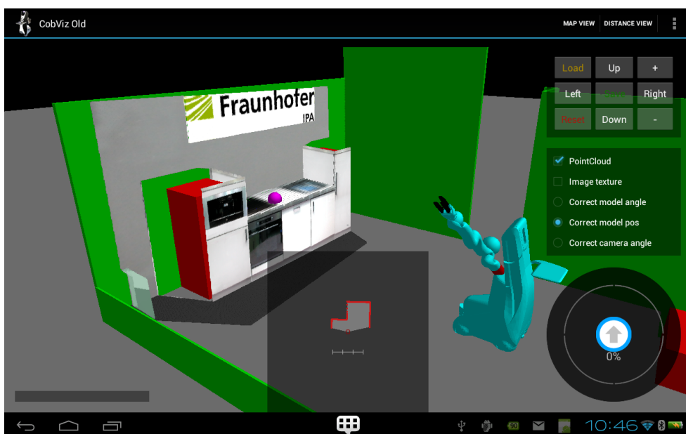
Obrázek 9.2: Zjednodušený model prostředí a korekce pozice vůči mračnu bodů.
