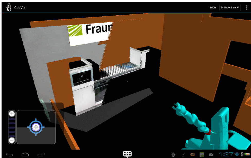
Obrázek 9.1: URDF model prostředí a nepřesnost zobrazení vůči mračnu bodů.
