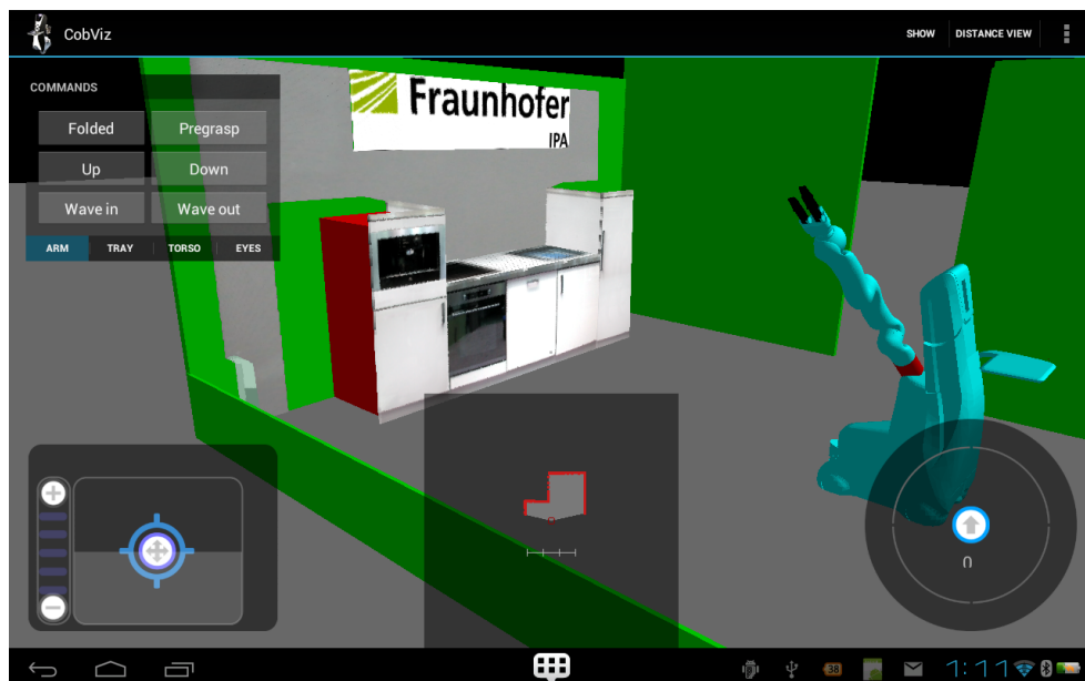
Obrázek 9.4: Ukázka z testování aplikace - panel příkazů, manipulátor kamery a joystick.
