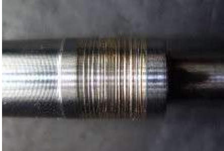
Obr. 8.4 Poškození hřídele znečištěným olejem [23]
