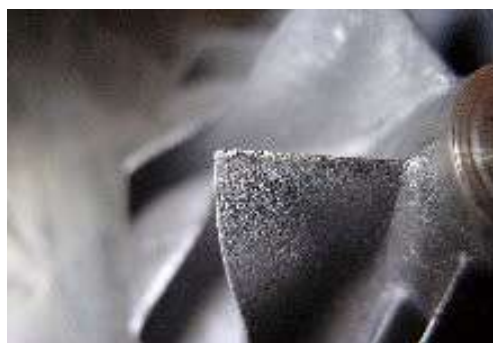
Obr. 8.1 Poškození kompresorového kola [23] Obr. 8.2 Obroušená lopatka kompresoru [23]
