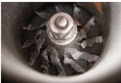
Obr. 8.1 Poškození kompresorového kola [23] Obr. 8.2 Obroušená lopatka kompresoru [23]
