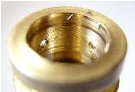
Obr. 8.6 Poškrábané hlavní ložisko [23]
