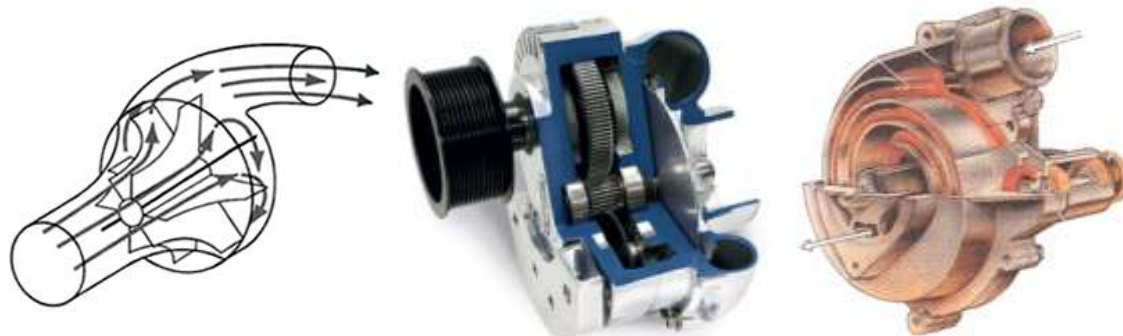
Obr. 2.7 Princip funkce a vzhled radiálního kompresoru [8][7]
