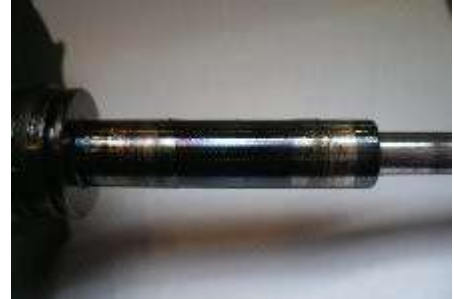
Obr. 8.5 Nedostatečně mazaný hřídel [23]
