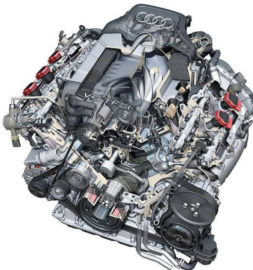
Obr. 2.4 Umístění Rootsova dmychadla na spalovací motor Audi V6 TFSI [5]
