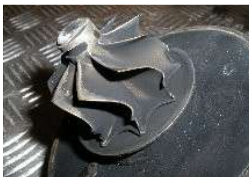
Obr. 8.3 Mechanické poškození turbíny [23]
