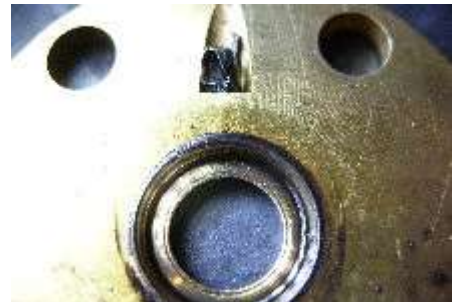
Obr. 8.7 Vydřený povrch axiálního ložiska [23]
