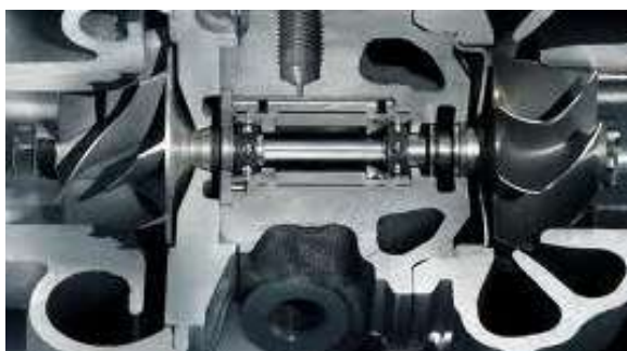
Obr. 7.6 Řez turbodmychadlem Twin-scroll [19]
