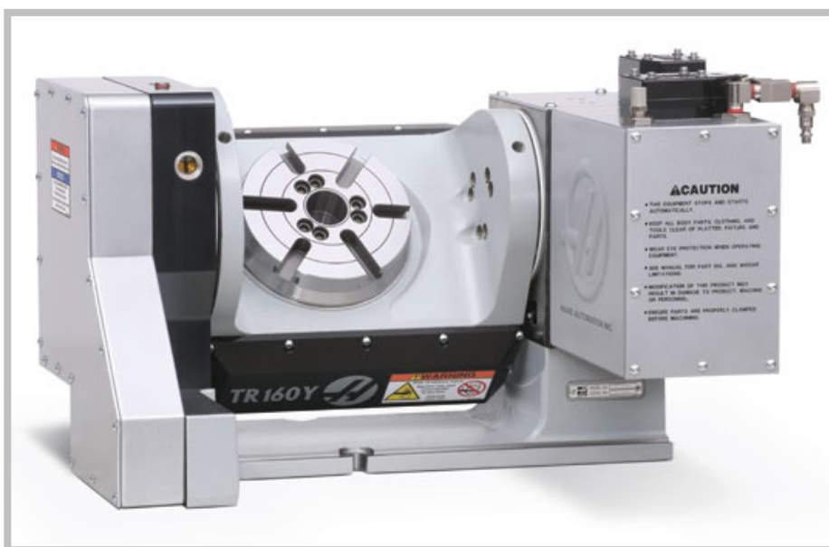
Obr. 2-1 Rotační naklápěcí stůl Haas TR 160 Y.
