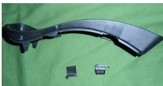
Obr. 1.2 Původní komponent s poškozenými úchytnými částmi.
