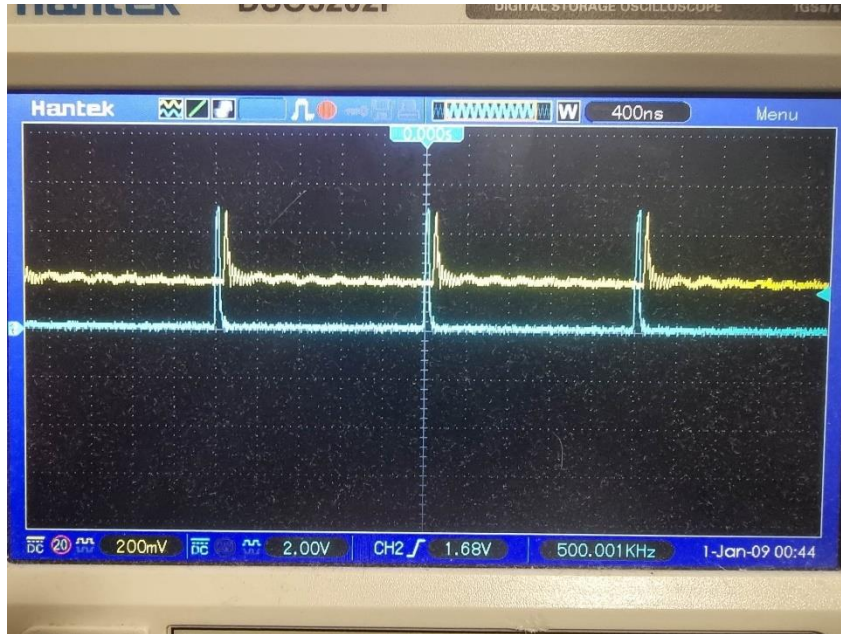
Obrázok 20 – Zvlnenie na výstupe regulátora pri zapojení jednej fázy, výstupnom napätí 200mV a výstupným prúdom 4A
