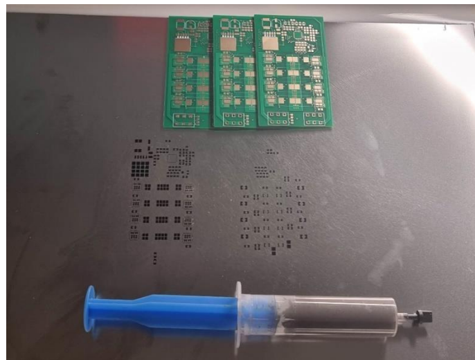
Obrázok 14 - Spájkovacia pasta a šablóna pre jej aplikáciu
