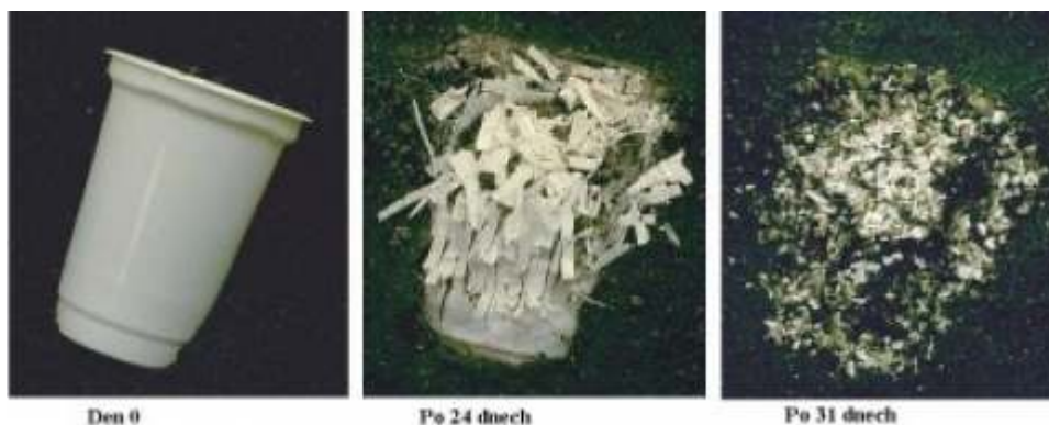
Obrázek 3: průběh rozkladu kelímku z ekologického plastu
