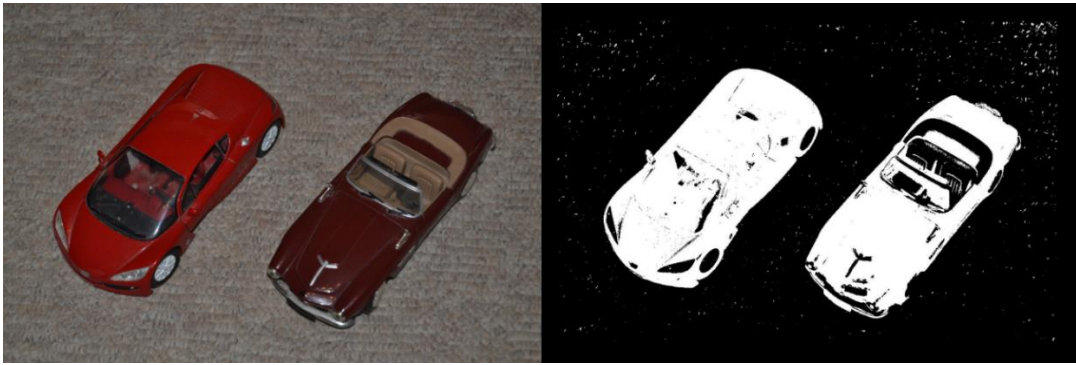
Obrázek 1.13 Prahování pomocí metody Otsu. Na obrázku vlevo si lze všimnout úskalí prahování, tedy nasvětlení objektů ze stran, kdy odlesky kapoty a skla se projeví i u nesprávné segmentace
