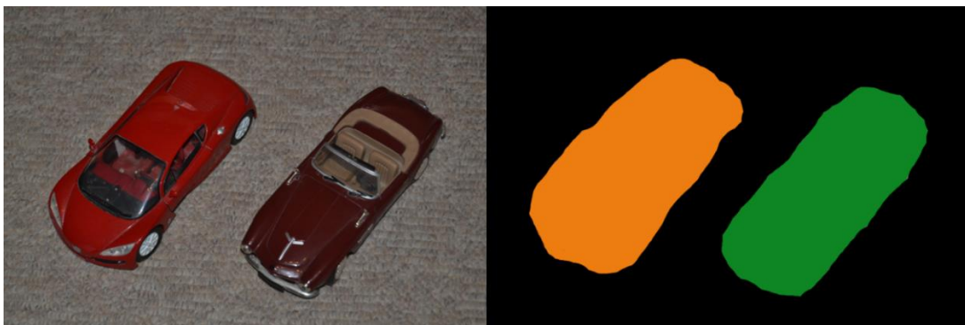
Obrázek 1.12 Instanční segmentace. Vpravo vstupní obrázek, vlevo výstup segmentace, kde je třída auto oddělena od pozadí, nicméně jsou od sebe rozlišena i jednotlivá auta jako samostatné entity
