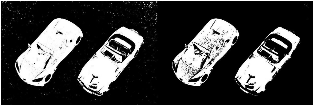
Obrázek 1.15 Erodovaný obraz s použitím strukturního elementu čtverce o rozměrech 11x11
