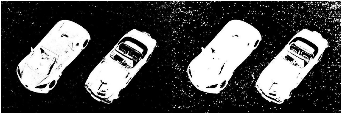
Obrázek 1.16 Původní binární obraz, (vpravo) Dilatace binárního obrazu s použitím strukturního elementu čtverce o rozměrech 11x11
