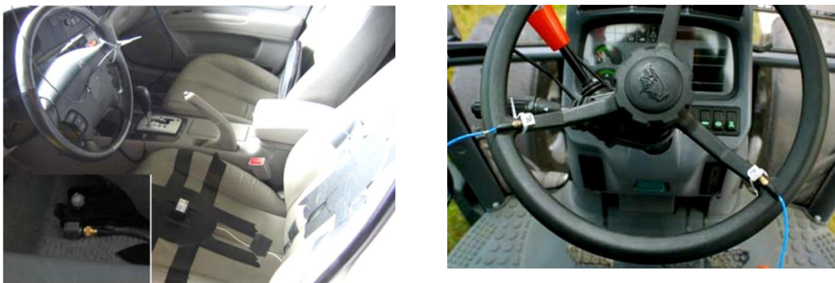
Obr. 2.5 a - umístění akcelerometrů a gyroskopu [17], b – umístění dvou akcelerometrů na volantů [20]
