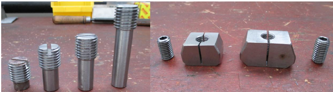
Obrázek 12-Vyvažovací tělesa, vlevo pro prostřední roviny, vpravo pro krajní roviny [6]
