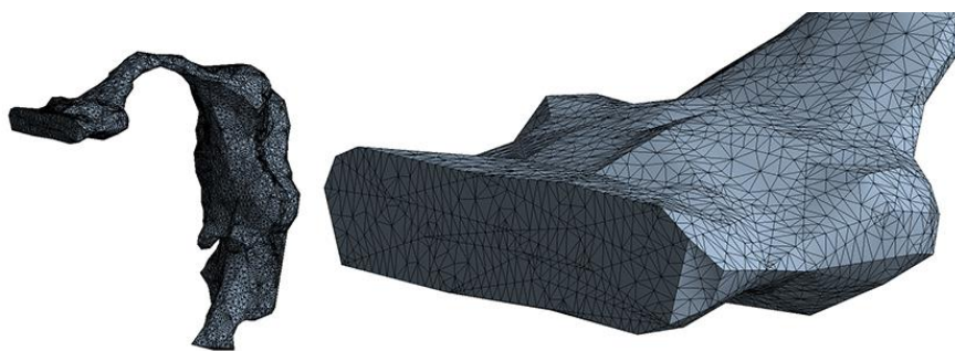
Obr. 6.4 Síť konečných prvků vokálního traktu nastaveného na vyslovování samohlásky /i:/
