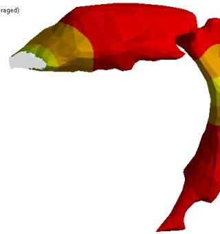
Obr. 6.17 Rozložení hladin akustického tlaku (SPL) ve vokálním traktu pro samohlásku /a:/ při frekvenci 1100 Hz
