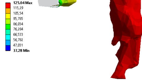
Obr. 6.19 Rozložení hladin akustického tlaku (SPL) ve vokálním traktu pro samohlásku /i:/ při frekvenci 200 Hz
