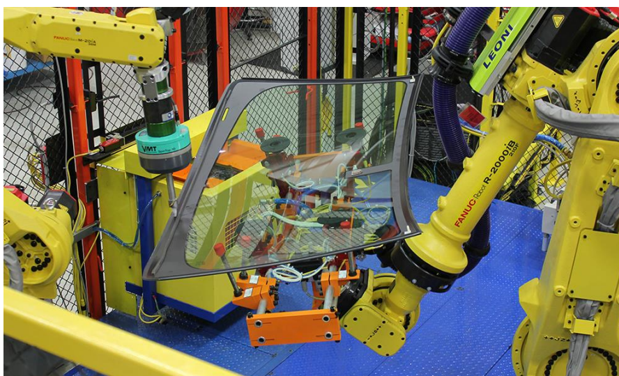
Obr. 8) Robotizované nanášanie lepidla na čelné sklo automobilu [9]
