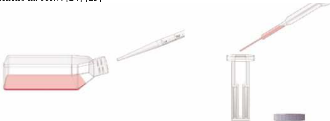
Obr 7 - Znázornění správného způsobu pipetování, vlevo do kultivační lahvičky, vpravo do centrifugační zkumavky [26]
