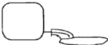
Obrázek 4.7.1 Únik kapaliny ze zásobníku, vznik louže
