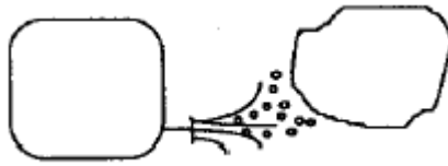
Obrázek 4.7.3 Únik kapaliny ze zásobníku, okamžitý vznik par
