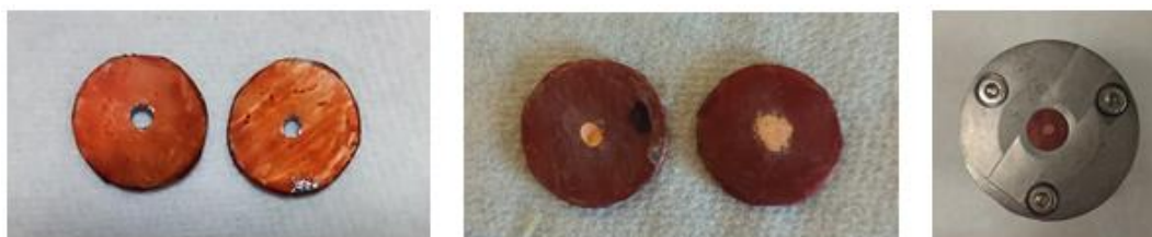
Obrázek 2: Postup přípravy záporné elektrody – olověný plech s vytvrzeným lepidlem a otvorem (vlevo), s nanášenou aktivní hmotou (uprostřed), uložené v In-situ (vpravo)
