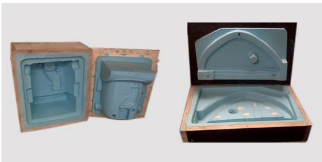
Obr. 18: Formy vyrobené metodou Soft Tooling [31]
