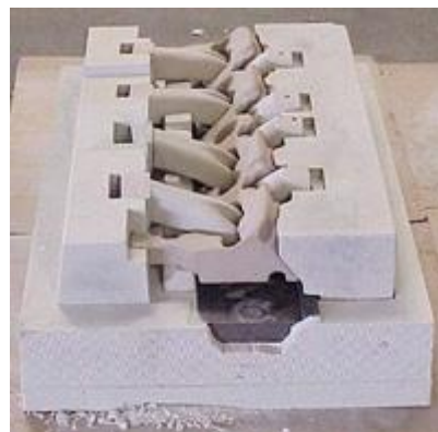
Obr. 16: Forma hlavy motoru vyrobená metodou DSPC [23]
