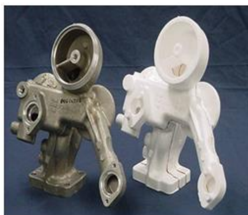
Obr. 22: Polystyrenový model a hotový výrobek [31]
