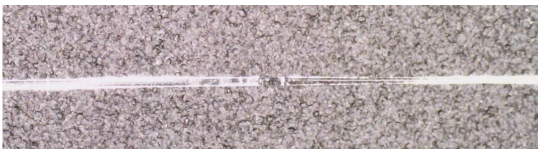
Obrázek 4.3 Fotografie taperu vytvořeného na svářečce Fujikura -FSM 100-P+
