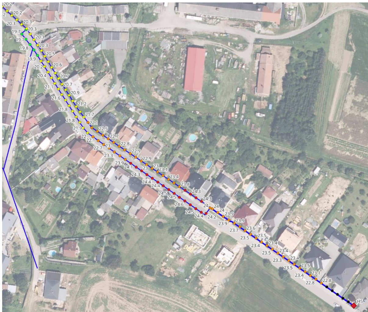
Obr. 26 Průběh teploty vody na úseku č. 6 v létě znázorněný v aplikaci QGIS
