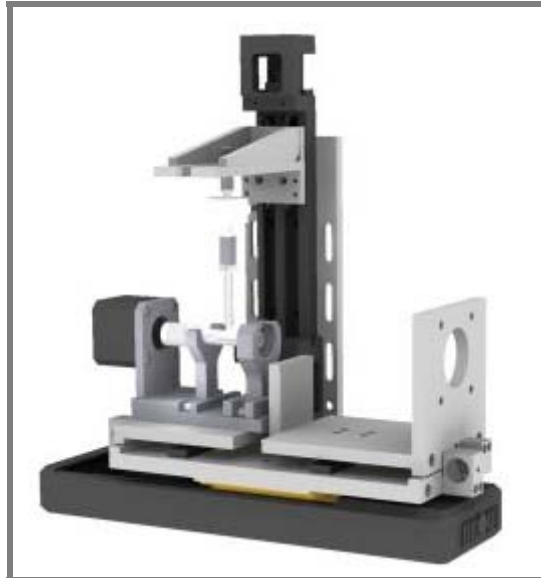
Obr. 6.5 Sestava aretačního posuvu a upínacího přípravku
