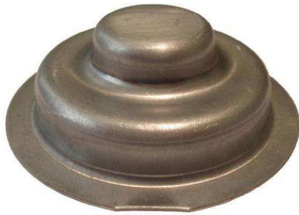
Obr. 4.3 Polotovár po třetí operaci
