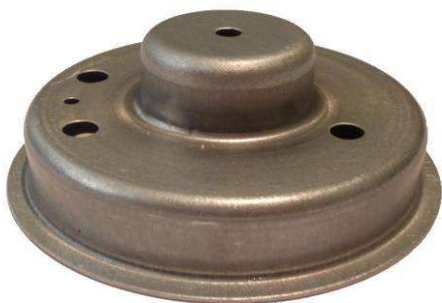
Obr. 4.6 Polotovár po šesté operaci
