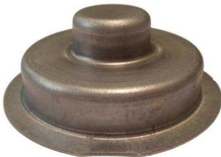
Obr. 4.5 Polotovár po páté operaci
