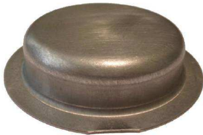
Obr. 4.1 Polotovary po první operaci
