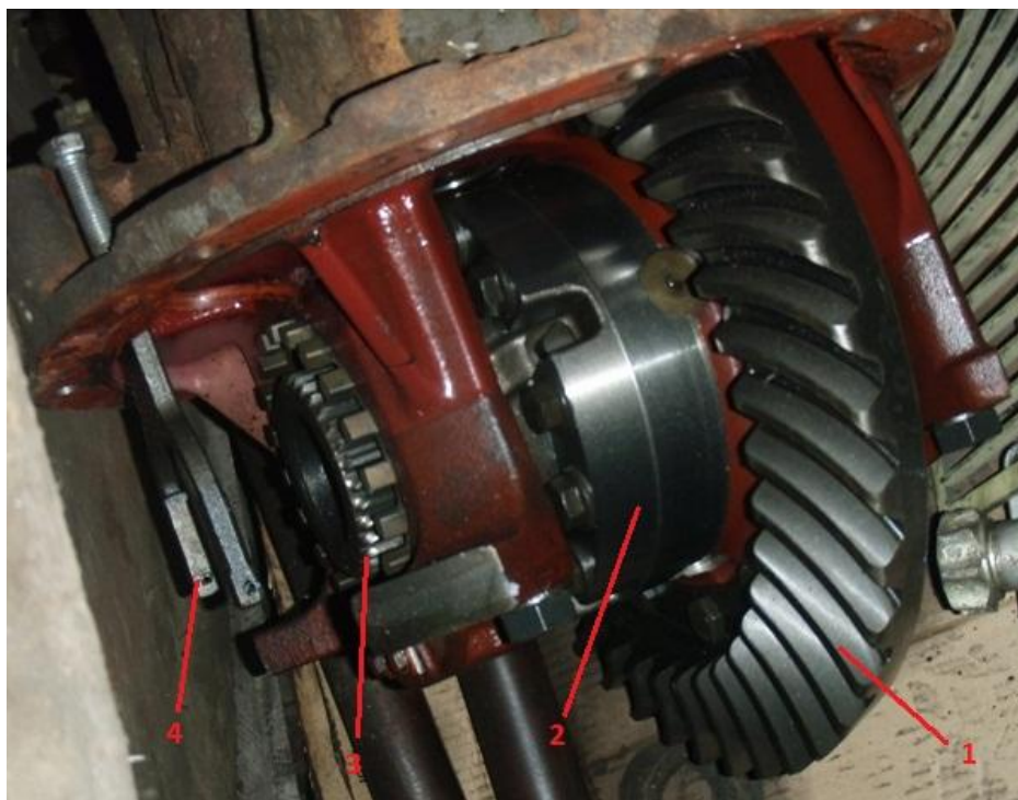
Obr. 5.7 Rozvodovka Karosa c734: 1 – talířové kolo, 2 – klec diferenciálu, 3 – drážky pro zasunutí uzávěrky diferenciálu, 4 – řazení uzávěrky diferenciálu
