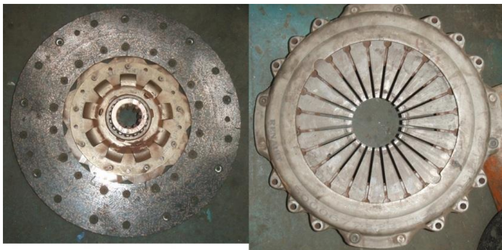
Obr. 3.3 Spojkový kotouč a membránová pružina z autobusu Renault
