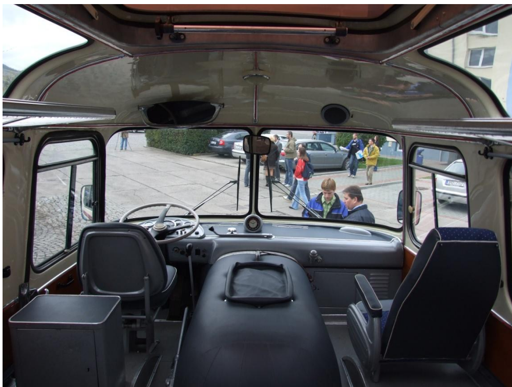
Obr. 2.2 Uložení motoru v kabině řidiče u autobusu Škoda 706 RT, který byl vyráběn národním podnikem Karosa mezi lety 1958 a 1972
