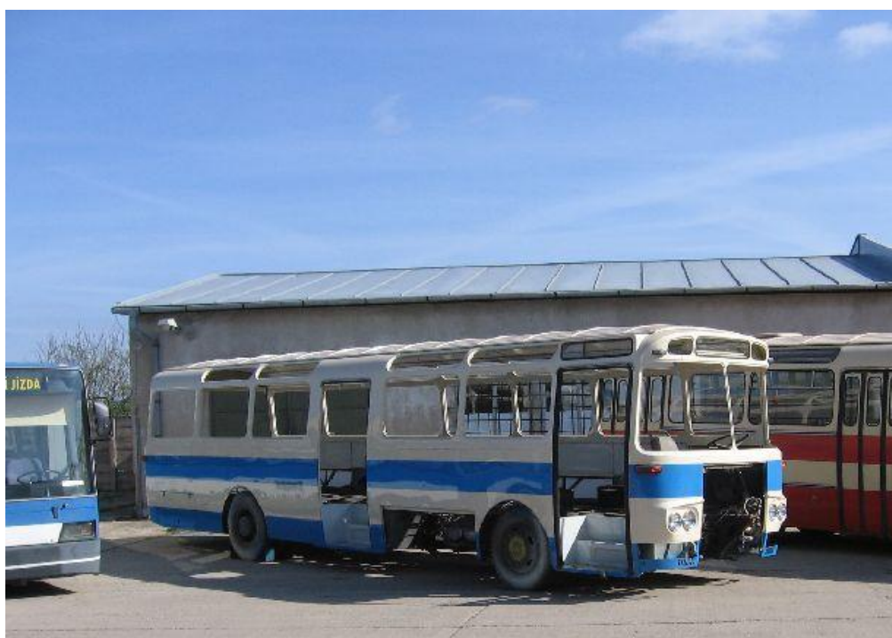
Obr. 2.3 Karosa ŠL 11 vyráběná v letech 1970 až 1981 s hnacím ústrojím uloženým mezi nápravami. Přístup k motoru je po otevření krytu za pravým předním kolem. Zvláštností hnacího ústrojí tohoto vozidla bylo uspořádání v pořadí: motor, spojka, kardan, převodovka, kardan, rozvodovka
