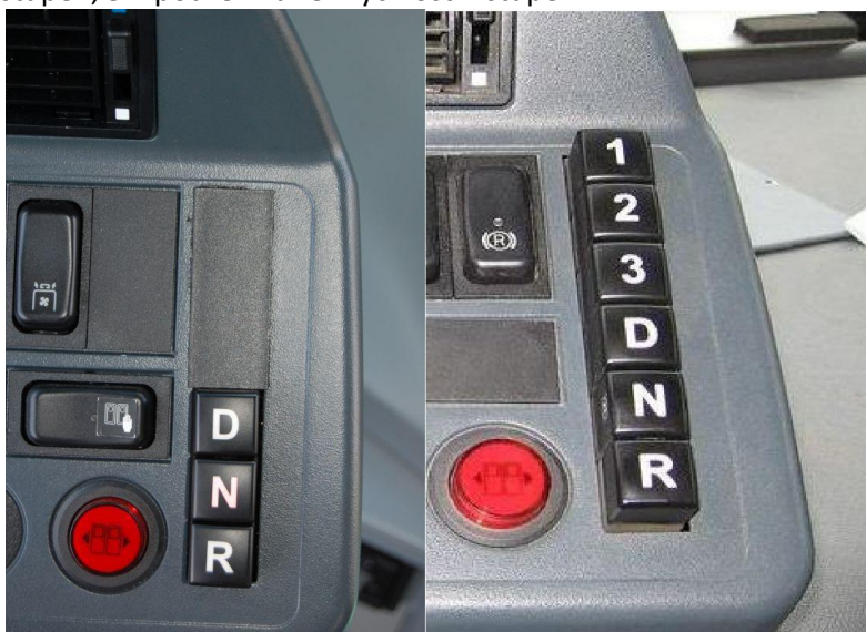
Obr. 4.11 Volící tlačítka automatické převodovky: Vlevo volící tlačítka automatické převodovky autobusu TEDOM C12 G, vpravo tlačítka automatické převodovky autobusu SOR NB 12 CITY
