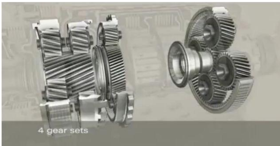
Obr. 4.14 Čtyři planetová soukolí automatické převodovky ZF 8-speed automatic transmission
