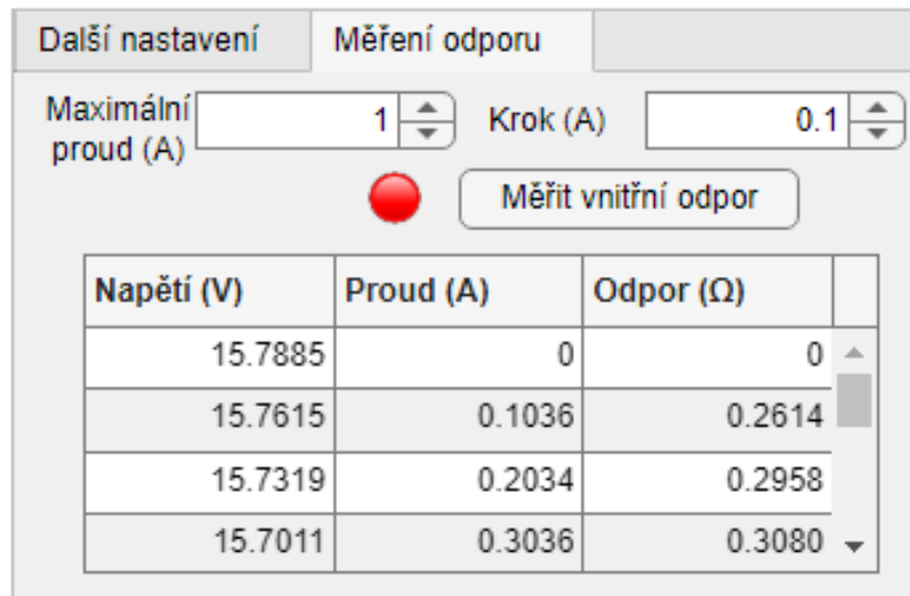
Obrázek 2.10 Měření vnitřního odporu baterie
