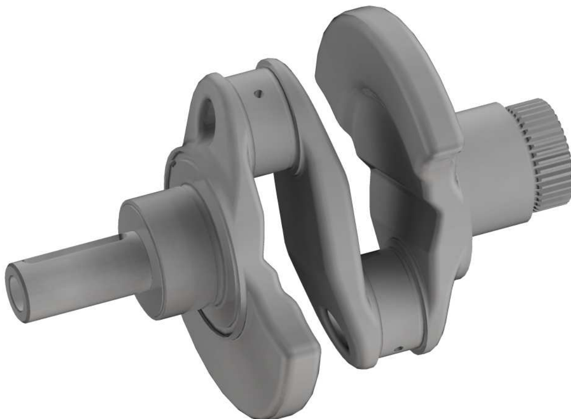
Obr. 2-2 Vlastní konstrukce klikového hřídele pro plochý dvouválcový zážehový motor
