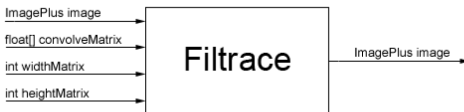
Obrázek 5.2: Principiální schéma komponenty pro návrh konvolučního filtru.
