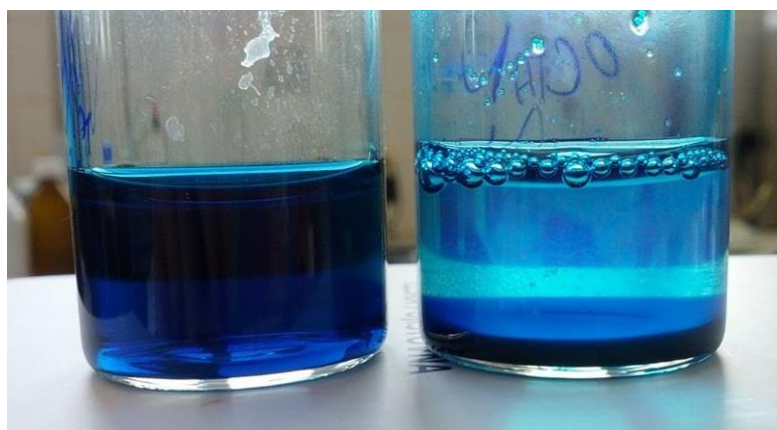
Obr. 8: Roztoky AB třetí den po rozpuštění, ve vodě je roztok stále čirý (vlevo), kdežto roztok AB v octanu sodném sedimentoval (vlevo) (19).
