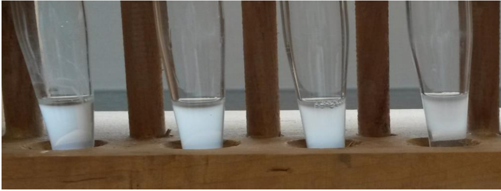
Obr. 41: Vzorky SG se standardním přídatkem HA o koncentraci (zleva) 0,02; 0,04; 0,06 a 0,8 % v poměru 1:1.
