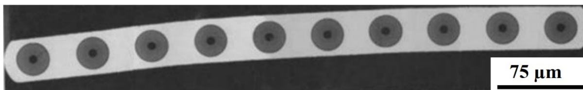
Obr. 7.2 – Průřez pásu s vlákny (mono tape) [6]
