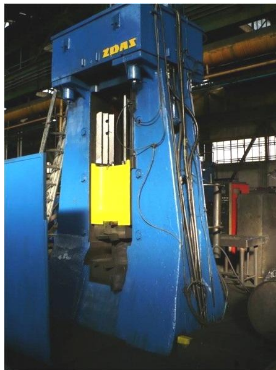
Obr. 17 Hydraulický buchar KPH 2000 [23]
