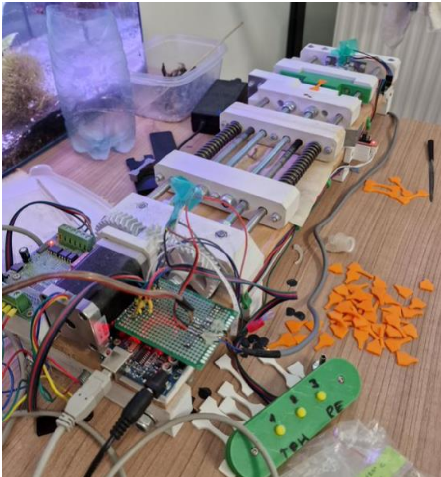
Obr. 49 Experimentální trhací zařízení
