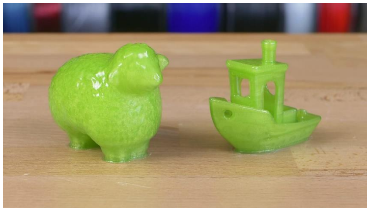
Obr. 26 Výtisk po vyhlazení Acetonem [52].
