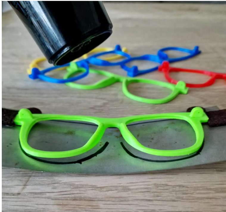
Obr. 68 Vytištěné stringovací modely
