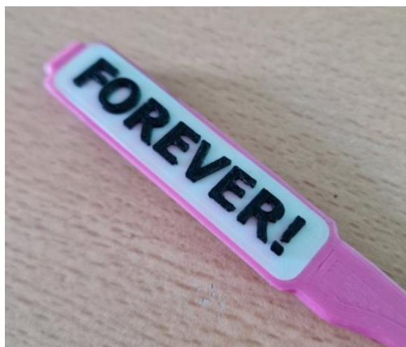
Obr. 45 Problém se změnou filamentu
