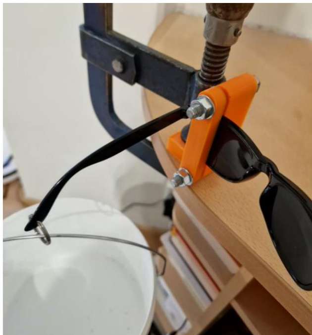
Obr. 41 Zatížení ve vertikální rovině
