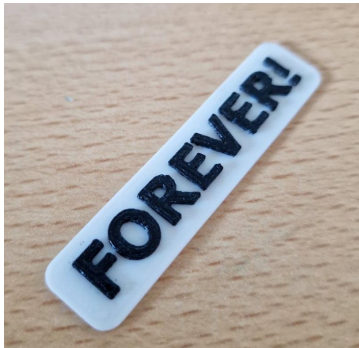
Obr. 48 Řešení změny barvy z programu Ultimaker Cura 5.2.1
