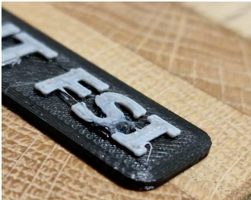
Obr. 46 Problém se změnou filamenty
