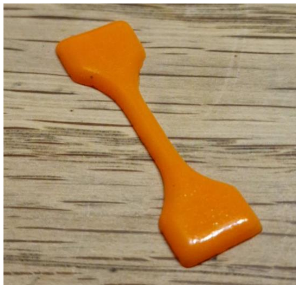
Obr. 54 Vzorek žiháný teplotou 130°C po dobu 30 minut
