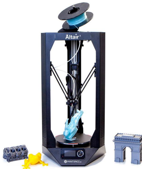
Obr. 20 Tiskárna typu delta [34].
