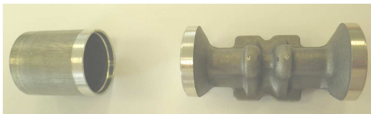
Obr. 3.14b Obrobené plochy před svařováním
