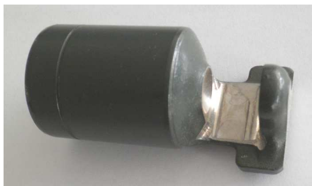
Obr. 3.14d Finální píst potažený vrstvou teflonu
