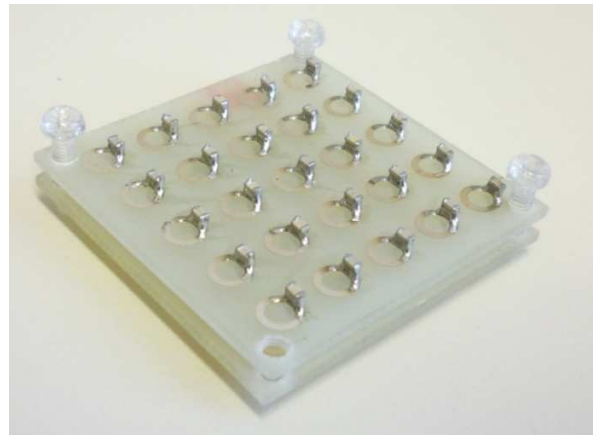
Obr. 8.2.2: a) Návrh struktury čočky. b) Realizace čočky [16].
